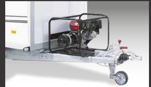
Stroomgenerator op de dissel
