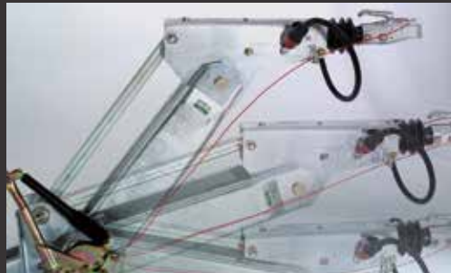
In hoogte verstelbare trekdissel (kogelkoppeling en DIN-sjorrog niet meegeleverd)
