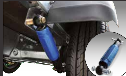
Wielschokdemper (gemonteerd) incl. 100 km/h goedkeuring Wielschokdemper (los) zonder 100 km/h goedkeuring
