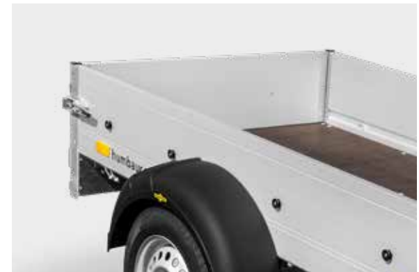
Zijwanden met geëloxeerd, dubbelwandig aluminium profiel
