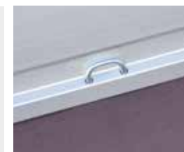
links In het dompelbad thermisch verzinkte trekdijsel rechts In de zijwanden ingebouwde siorringen
