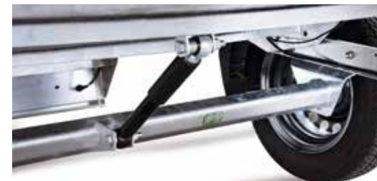
Kantelbare opbouw van het hok (kantelbaar bij de HA) met schokdemperondersteuning
