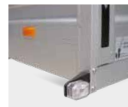
links Zijdelingse begrenzingslichten aan de voorkant rechts Klep met verzonken sluitingen
