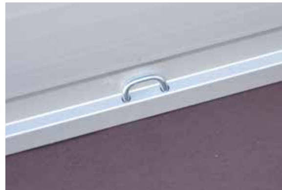
In de zijwanden geïntegreerde sjorringen (6 stuks) standaard
