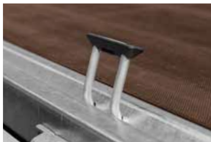
Direct in het buitenframe geïntegreerde sjspringen (4 stuks)
