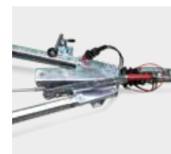
links In het dompelbad thermisch verzinkte trekdijsel rechts In de zijwanden ingebouwde siorringen
